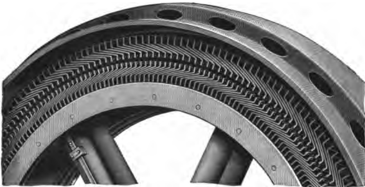
Rücklaufende Wellenwicklung mit Gabelverbindungen der Siemens-Schuckert-Werke.
